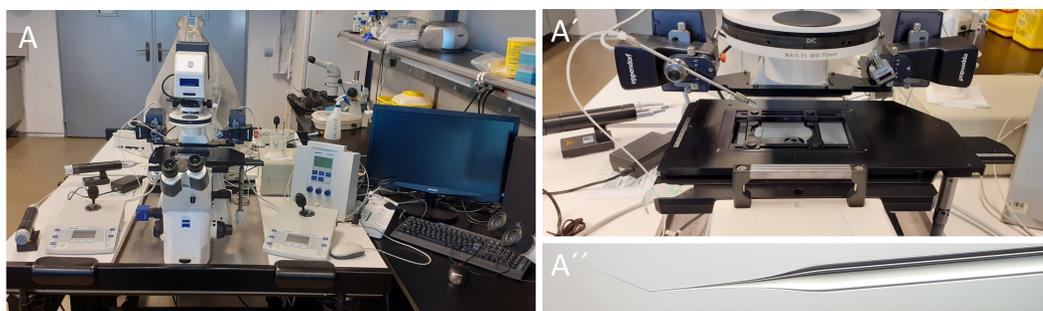
Zeiss Observer D1, micromanipulador Transferman Nk2, bomba de inyección FemtoJet (Eppendorf) (A-A'). Ejemplo de agujas utilizadas en nuestros ensayos (A'').
